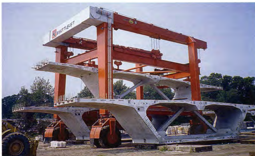
Fig. 8. 300-ton (272 t) travel crane.
