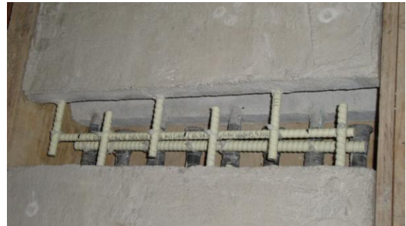
(d) Closure strip for slab S6
