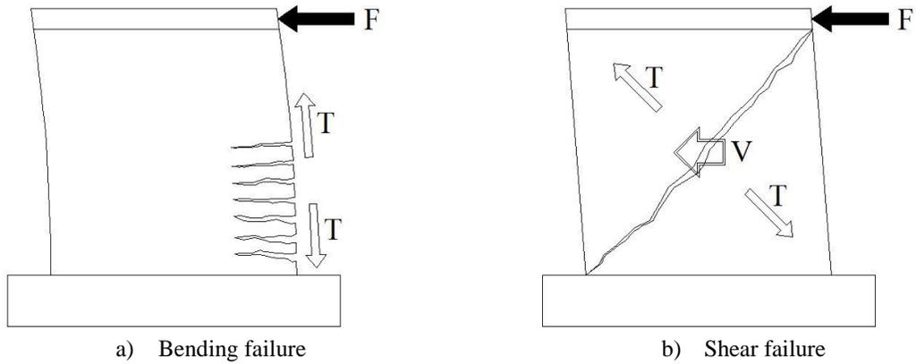
**Figura 1** *Falla por flexión y falla por tensión diagonal*
